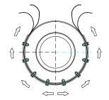
Bei offenen rechteckigen Kompensatoren von den Ecken aus arbeiten. Kompensator gleichmäßig zwischen den Verschraubungen verteilen
